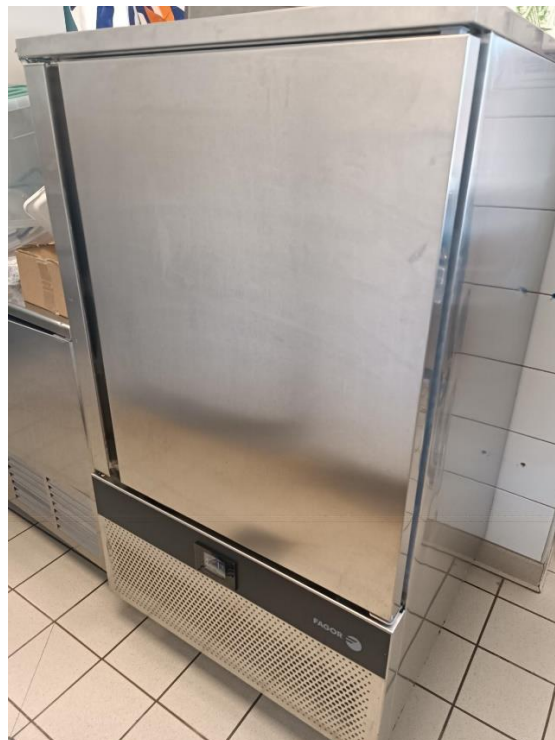
Cellule de refroidissement
